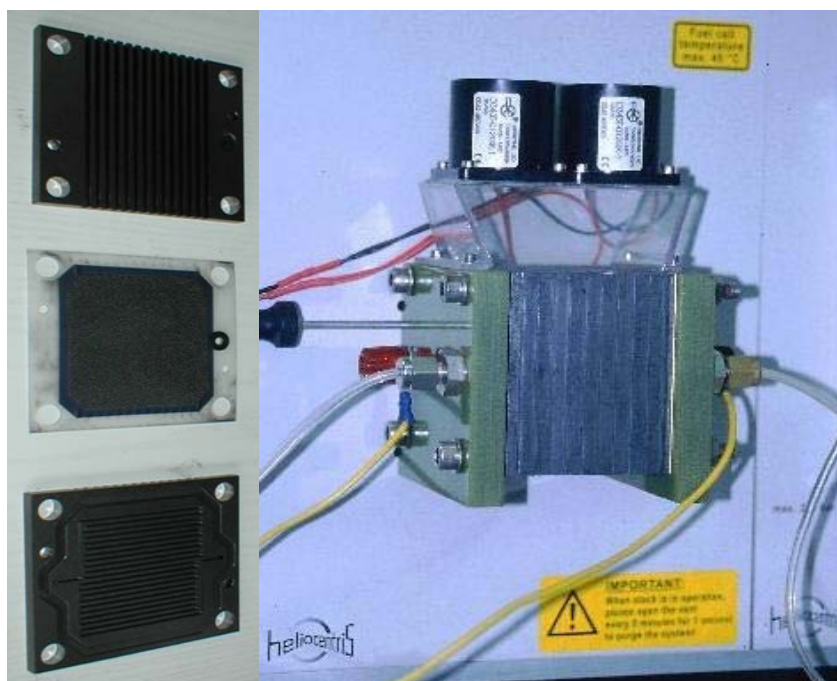
Rys. 3.3. Rozłożona pojedyncza cewa i cały stos tworzący ogniwo paliwowe; ogniwo paliwowe PEM firmy Heliocentris GmbH
