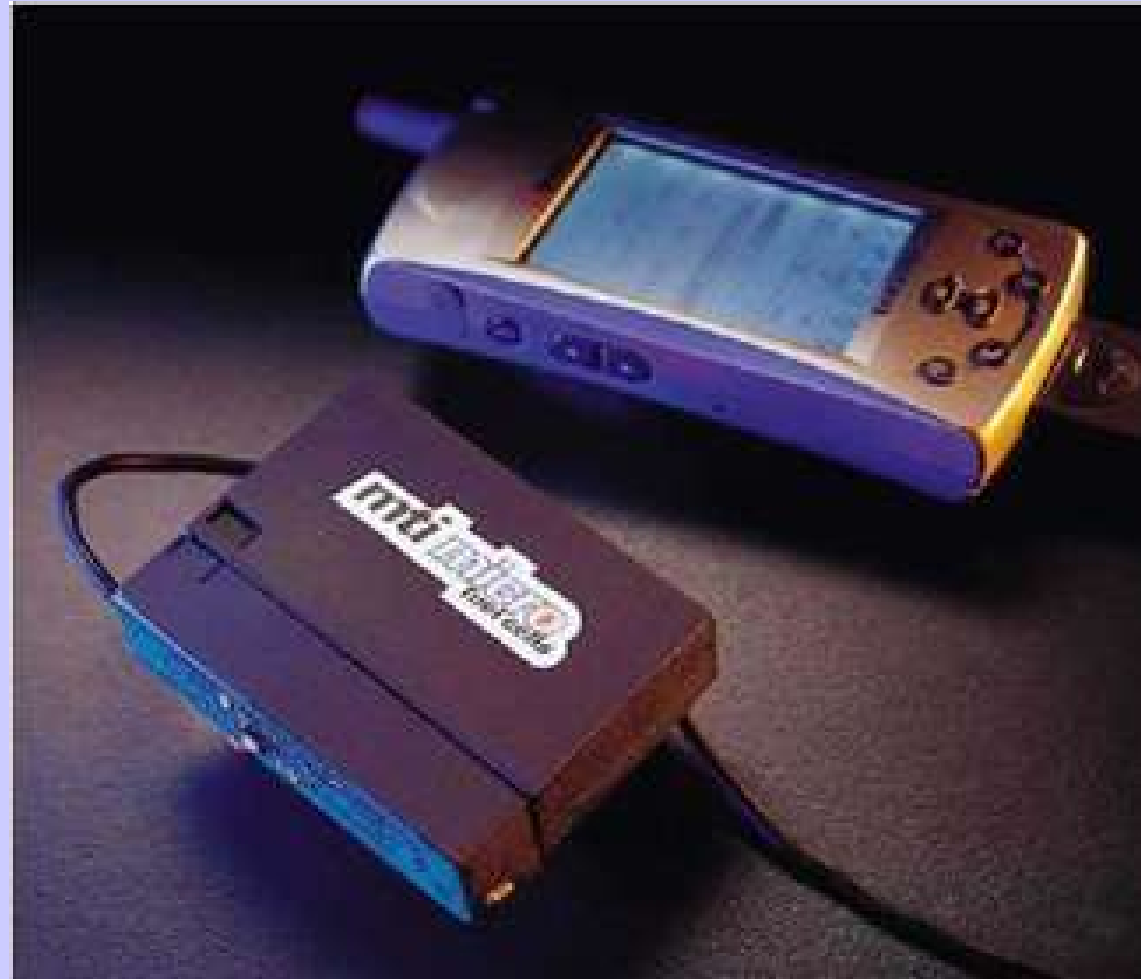
Ładowarka baterii do komórek na bazie ogniwa metanolowego, Mechanical Technologies
